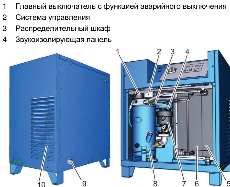
Рис. 9: Тип 6 – 15 Обзор узлов
